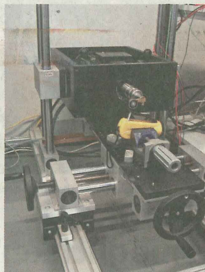
Test der Lebensdauer einer Taschenlampe für den Wettbewerb an der Schaffhauser Tischmesse.
