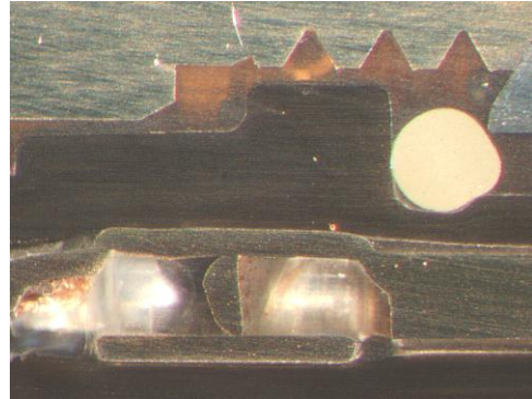
Deformierter Dichtungsring (Schnittebene 90° versetzt)
