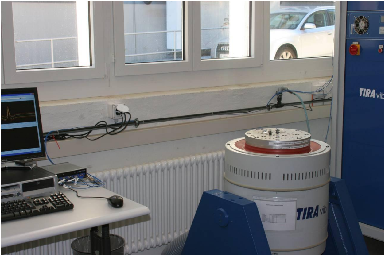
Ansicht des Schwingungsprüfstandes: Links Frontend (kleines Kästchen neben Bildschirm), Mitte Rütteltisch (mit zwei Beschleunigungssensoren), rechts Verstärker
