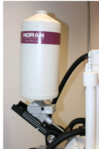
SiLi-Halbleiterdetektor mit Kühllryostat für flüssigen Stickstoff
