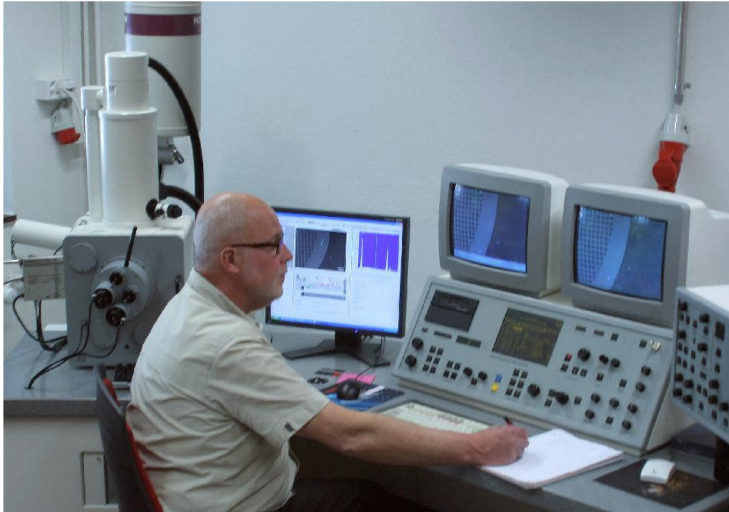
Rasterelektronenmikroskop: Links elektronenoptische Säule (Röntgendetektor dahinter) und Probenkammer, Mitte und rechts Bedienpult
