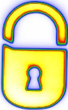
Von hinten beleuchtetes Schaltersymbol - Falschfarbendarstellung der Leuchtdichte
