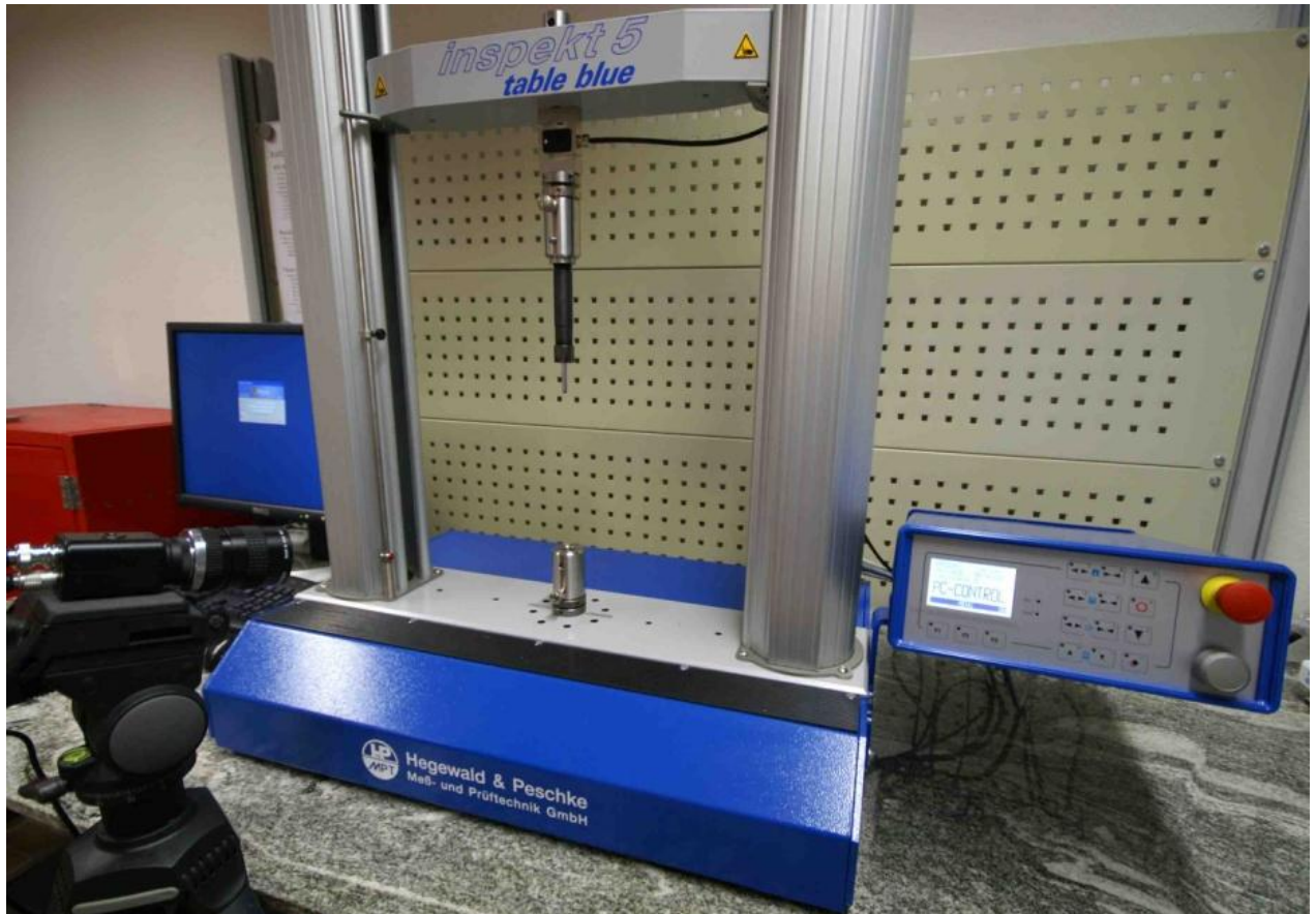
Gesamtansicht der Universalprüfmaschine mit Videokamera
