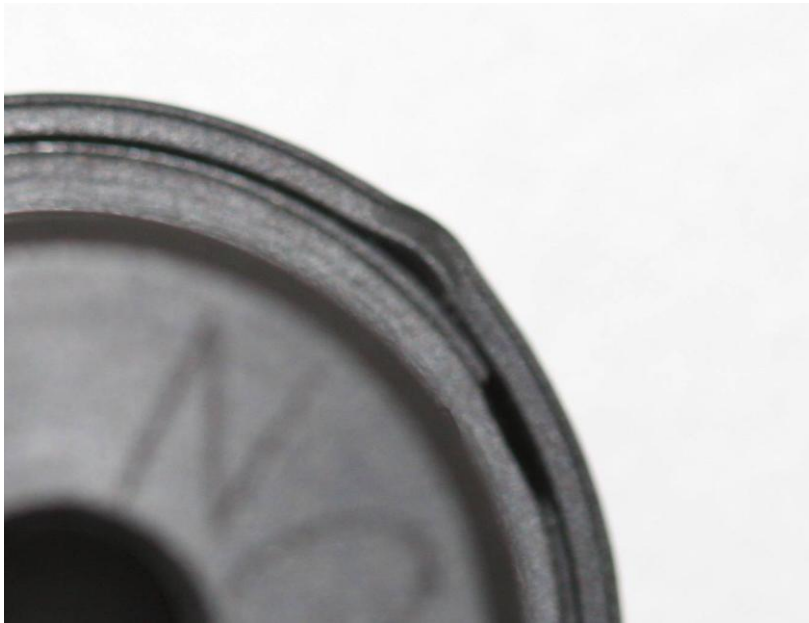
Wandverbiegung an einem Kunststoff-Prüfling nach Klimatest
