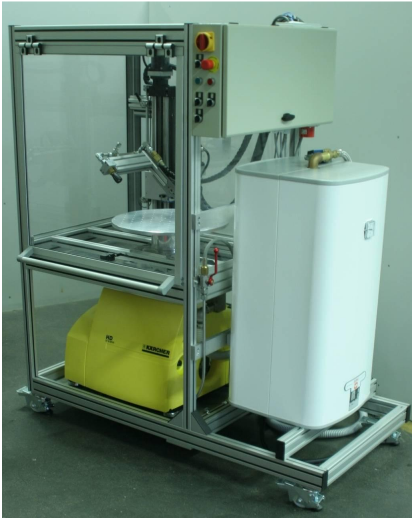
IPX9K-Messplatz: Prüfkammer, Heisswasserboiler und Hochdrucksystem
