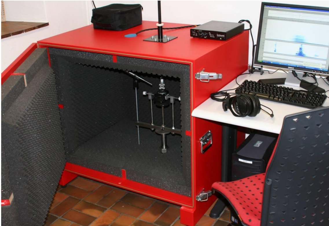
Akustikmessplatz: Messkammer, Prüflingshalterung, Mikrophon und Verstärker
